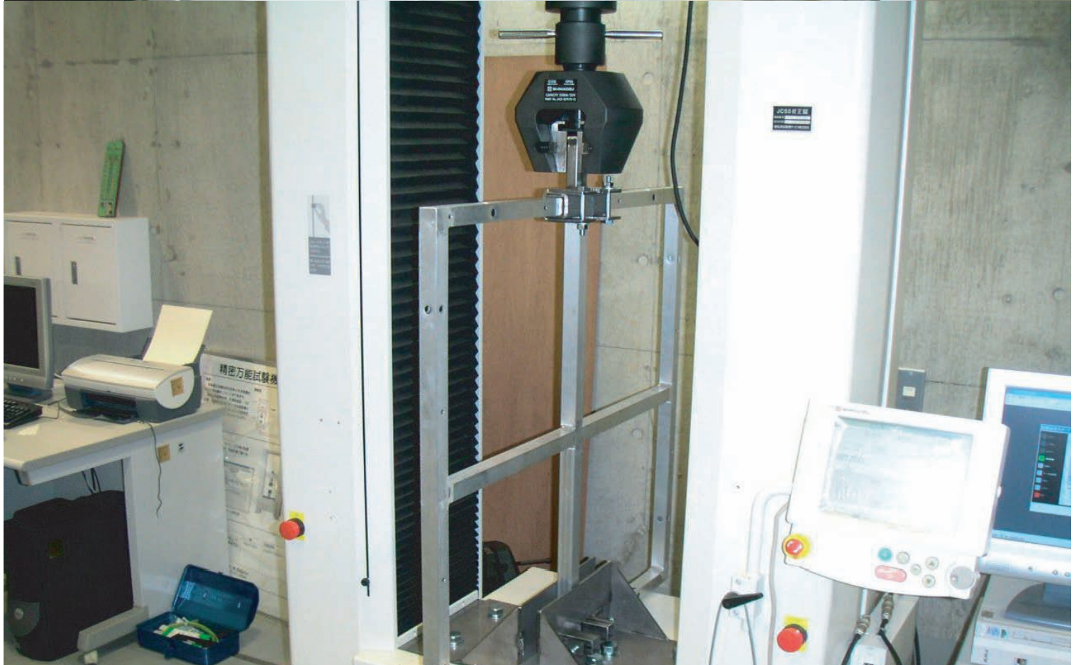
インストロン型引張試験機による強度試験 250kNの試験機による圧縮試験
